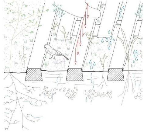
Las piezas se conciben como elementos estructurales que actúan como prótesis para proteger el terreno de aplastamiento por el paso de vehículos. Como corresponde a un pavimento, las piezas trabajan principalmente a compresión (debiendo asegurar en su instalación que el apoyo de las piezas sea continuo) pero también con una cierta resistencia a flexión que garantiza en reparto lineal de cargas en el terreno, proporcionada por la presencia de fibras plásticas.
